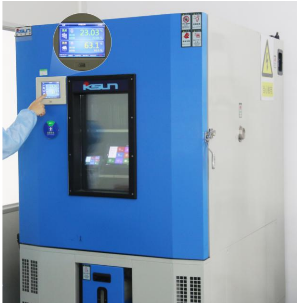
图 5-7 高低温老化测试图
