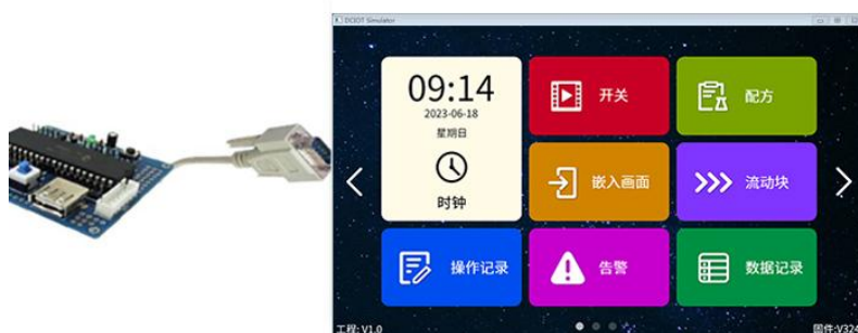
图 7-2 用户单片机串口与“HMI 模拟器”联机调试
